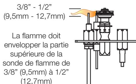
La flamme doit envelopper la partie supérieure de la sonde de flamme de 3/8" (9,5mm) à 1/2" (12,7mm)
