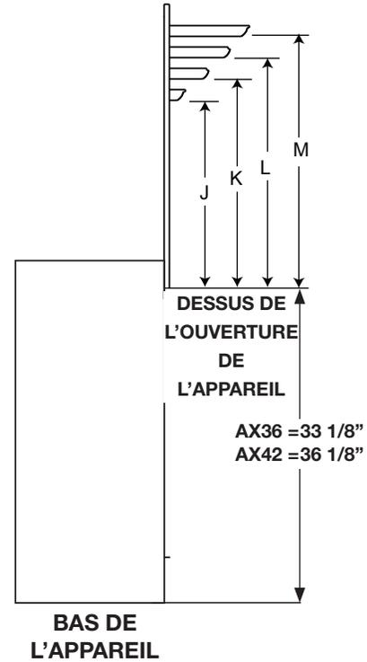
**UNIQUEMENT** si le système de gestion thermique **Altitude<sup>MD</sup> X** est installé, les dégagements de la tablette peuvent être réduites.
