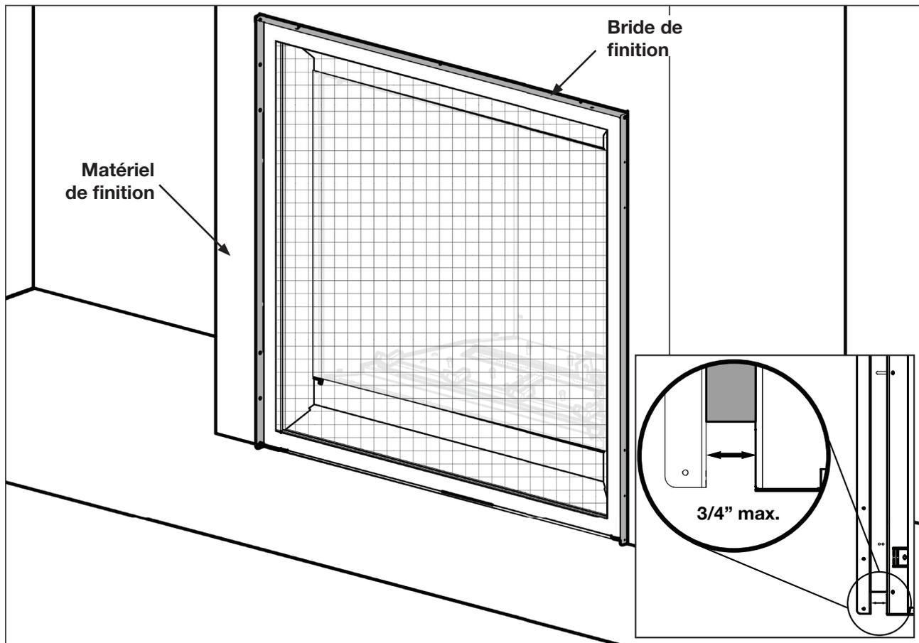
La bride de finition (la bride de finition définit le périmètre de l'ouverture de l'appareil. Les matériaux d'ossature ou de finition NE JAMAIS empiété à l'intérieur de la bride de finition).
