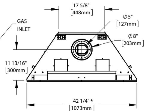
\* La bride de finition (la bride de finition définit le périmètre de l'ouverture de l'appareil. Les matériaux d'ossature ou de finition NE JAMAIS empiété à l'intérieur de la bride de finition).
