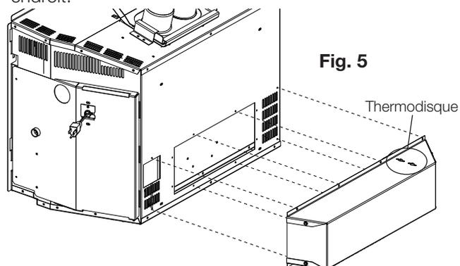
6. Desserrez le support du thermodisque (2 vis). Faites glisser le support jusqu'à ce que le thermodisque touche l'arrière du foyer et puis fixez (**Fig. 6**).
