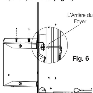
7. Réinstallez la plaque d'accès de côté. Branchez le cordon d'alimentation de l'appareil dans la prise murale la plus proche.
