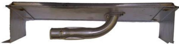
Accédez au volet d'air situé dans le bas du brûleur à plateau. Plus le volet est fermé, plus la flamme est jaune et aura tendance à causer des dépôts de carbone. Plus le volet est ouvert, plus la flamme est bleue et plus elle a tendance à se détacher des orifices du brûleur. La flamme peut ne pas être jaune immédiatement; allouez de 15 à 30 minutes pour que la couleur finale de la flamme se stabilise.
