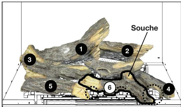
6. Avec la souche vers le haut, placez l'extrémité droit de bûche n° 6 sur le plancher de la chambre de combustion, au dessous de la tige de chenet 5ème. Placez l'extrémité opposé au dessus de la tige de chenet 3ème.
