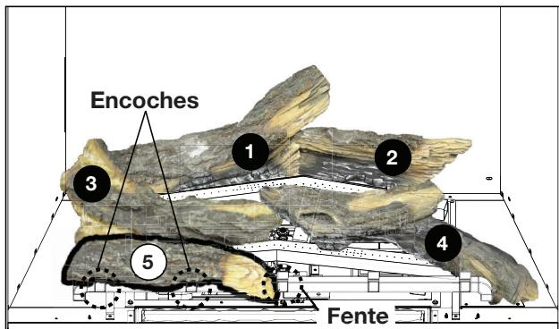
5. Placez les 2 encoches dans bûche n° 5 sur la tige de chenet 1er et 2ème. Assurez-vous que l'encoche sur la fente s'enroule autour de la tige de chenet 3ème.
