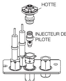
4. Desserrez et retirez le tube de la veilleuse du boîtier de la veilleuse. Remplacez l'injecteur et réassemblez.
